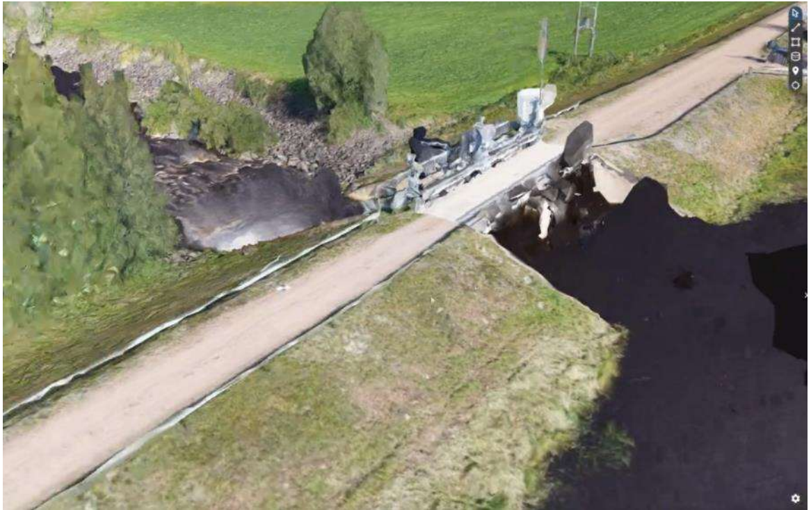
Kuvio 10. Esimerkkikuvankaappaus droonilla kuvatun pistepilviaineiston avulla tehdystä maastomallista (EPO ELY 2020).
