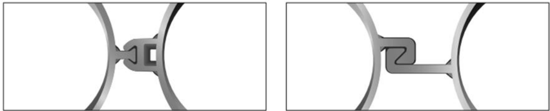
Kuva 61. Paaluputkien kiinnittämistä varten käytettävät lukkoprofiilit, vasemmalla RM/RF-lukko ja oikealla E21-lukko. [66]
