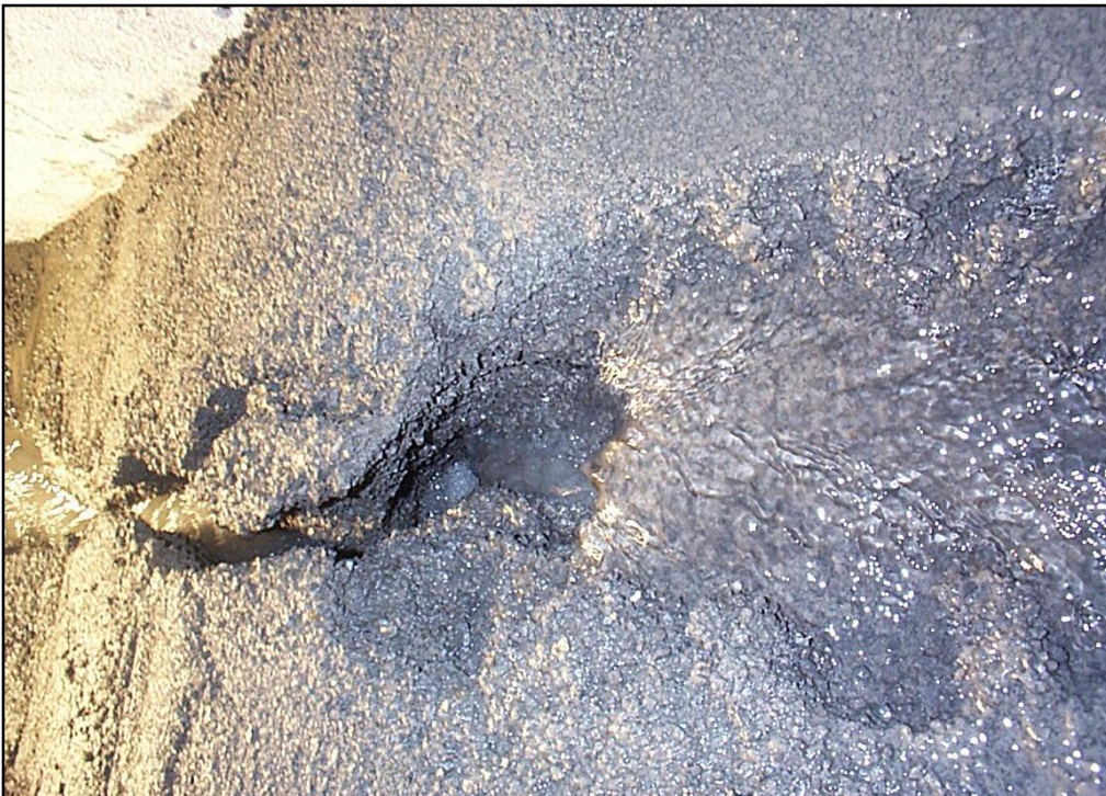
Kuva 18. Ylivirtaus maapadolla laboratorio-olosuhteissa. [19]
