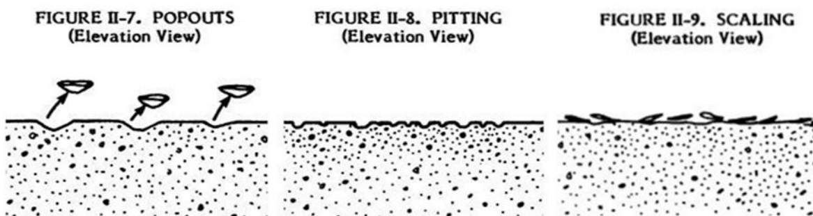
Kuva 29. Betonin pintavauriotyyppejä, vasemmalta alkaen: lohkeilu, säröily, rapautuminen. [38]
