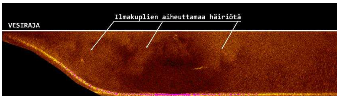
Kuva 18. Vuodon seurauksena syntyvät ilmakuplat voimalaitoksen alapuolella.
